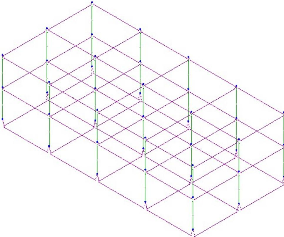
Dalle illustrazioni precedenti si evince come le aste, sia travi che pilastri, siano schematizzate con un tratto flessibile centrale e da due tratti (braccetti) rigidi alle estremità. I nodi vengono posizionati sull'asse verticale dei pilastri, in corrispondenza dell'estradosso della trave più alta che in esso si collega. Tramite i braccetti i tratti flessibili sono quindi collegati ad esso.
