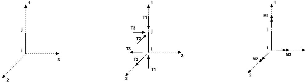
Definiti i e j come i due nodi iniziale e finale del pilastro, viene individuato un sistema di assi cartesiani 1-2-3 locale all'elemento, con origine nel Nodo i così composto:
