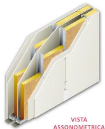
interposto isolamento acustico realizzato con doppio strato di pannelli in lana tipo Ekovetro, dello spessore ognuno di mm 45, e lambda 0,037W/mK accoppiate su faccia interna della parete;
